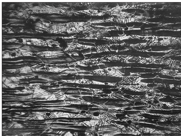
Полисинтетически-сдвойникованная линзовидно-полосчатая текстура ковanej мышьяковой бронзы ножей. Полированный шлиф, протравленный в растворе хромпика в серной кислоте и аммиачном растворе медной соли. Увел. 200.
